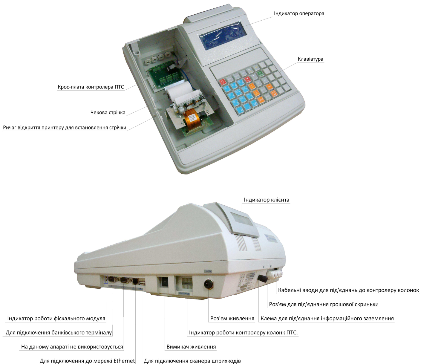
Рисунок 1 – Розміщення елементів управління індикації та комутації
